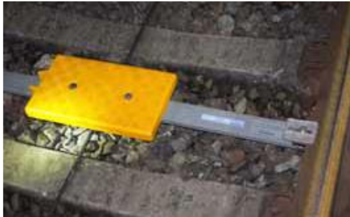
Eksempel på balise monteret på skinner mellem 2 sveller
