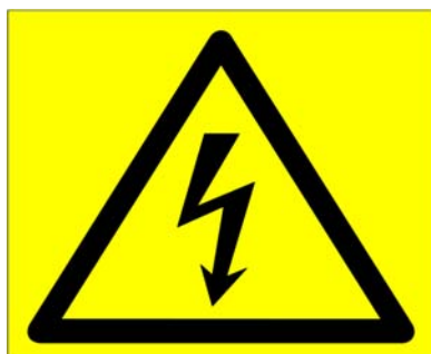
Figur 11.1.8.2-3 Advarselstavle for farligt elektrisk område.
