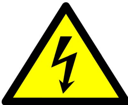
Figur 10.6.1-1 Advarselsskilt mod farlig elektrisk spænding ifølge Arbejdstilsynets bekendtgørelse 624 af 4. maj 2015 [8]. Klistermærker er ikke tilladt på Corten-konstruktioner af korrosionstrægt stål.
