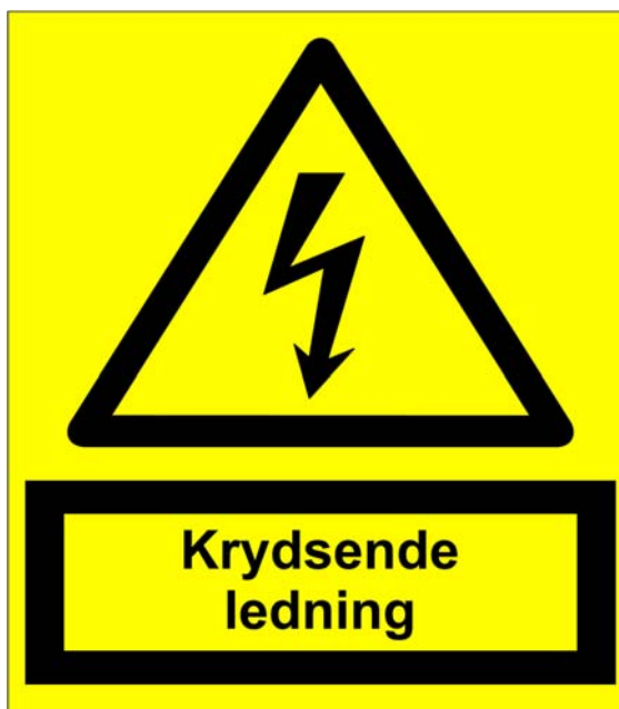
Figur 11.1.8.2-5 Advarselstavle for krydsende ledning.
