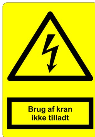
Figur 10.3.2-3 Brug af kran ikke tilladt. Skiltet benyttes på områder, hvor maskiner og større redskaber kan komme for tæt på køreledningsanlægget.
