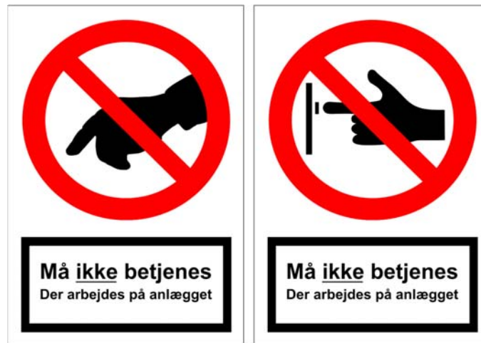
Figur bilag 10-3 Forbudsskilt "Må ikke betjenes": På bagsiden skal noteres dato, navn samt telefonnummer på den person, der foretager spærringen.
