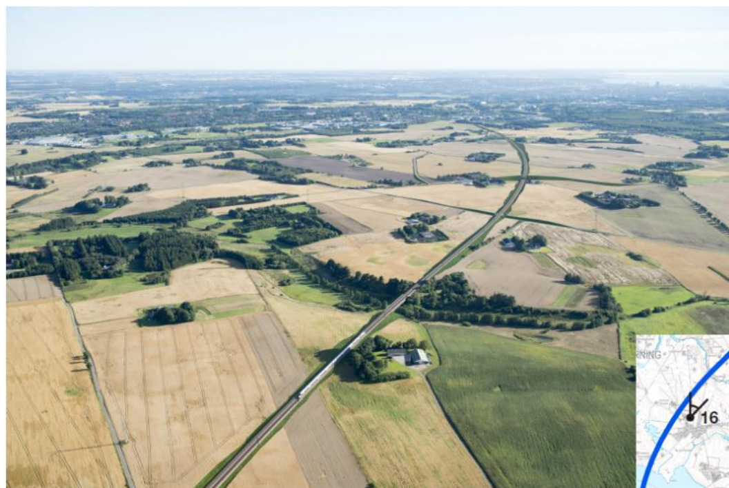
Figur 36. Visualisering af Vestlig linjeføring over Århus Ådal og Ingerslev Hede. Visualiseringen viser banen liggende på dæmning, men grundet hensyn til Bering-Beder vejen er banen efterfølgende lagt i afgravning.
